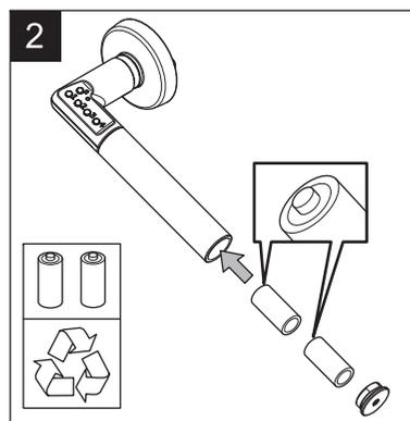
2. Appuyer sur la béquille et laisser les deux piles glisser à l'extérieur. Remplacer avec deux nouvelles piles. Attention au sens d'introduction des piles.
