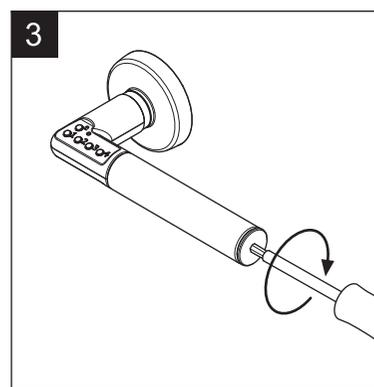
3. Replacer en vissant le capot de fermeture.
