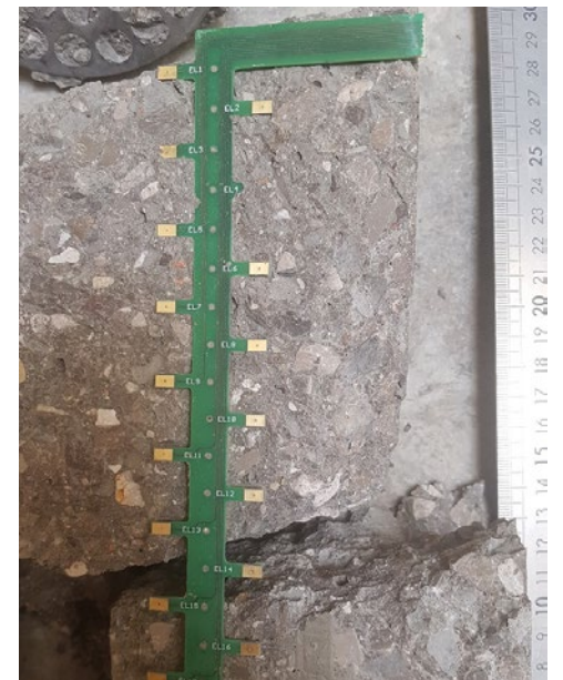
Échelle de résistivité après fendage d'une éprouvette de béton C60 de l'Andra © J. Badr et G. Villain (MAST-LAMES)
