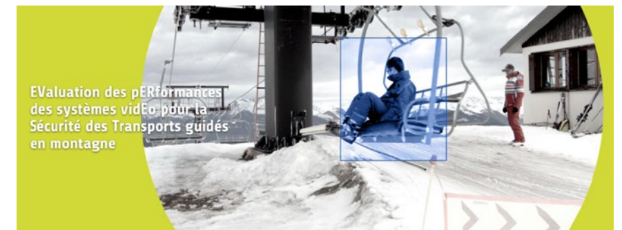
Détection de situation à risque (présence d'un usager après débarquement) par analyse d'images dans le cadre du projet EVEREST © Université Gustave Eiffel
